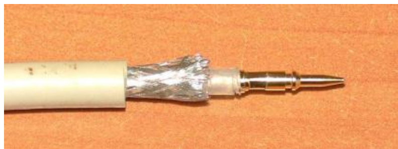
Рис. 5.3. Коаксиальный кабель RG-58 после установки и обжима центрального контакта
