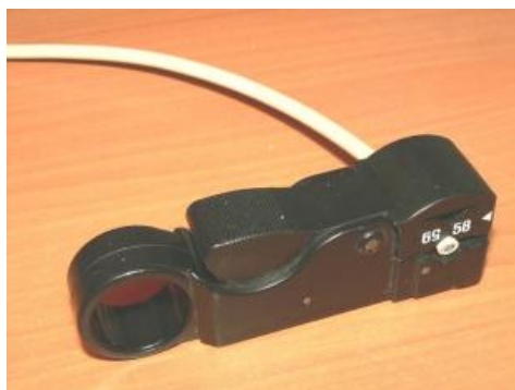
Рис. 5.1 Коаксиальный кабель RG-58 в устройстве для его зачистки
