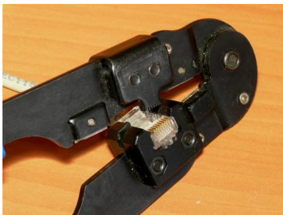
Рис. 5.8. Коннектор RJ-45 в обжимном инструменте
