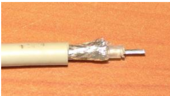
Рис. 5.2. Коаксиальный кабель RG-58 после зачистки
