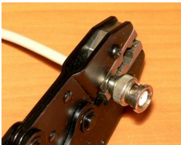
Рис. 5.5. Коннектор BNC в обжимном инструменте
