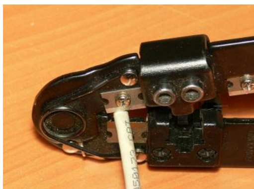
Рис. 5.6. Обрезка внешней изоляции на кабеле «витая пара»
