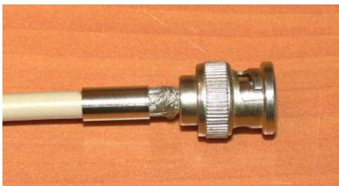
Рис. 5.4. Коаксиальный кабель с установленной основной частью коннектора и не полностью надетой обжимной трубочкой
