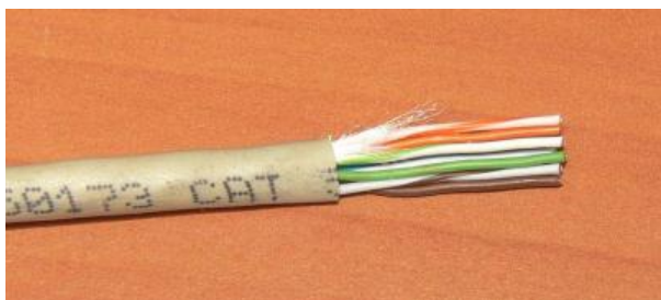
Рис. 5.7. Кабель «витая пара» с расплетенными и выпрямленными проводниками
