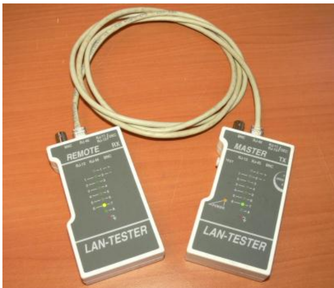
Рис. 5.9. Проверка качества заделки коннекторов RJ-45 с помощью специального тестера
